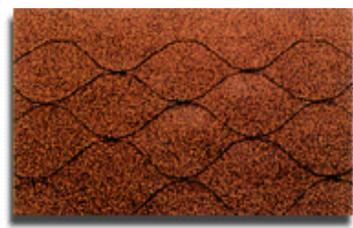
*Figura 1.4: Muestras de teja asfáltica. Fuente: [www.ciam.ucol.mx](http://www.ciam.ucol.mx).*
